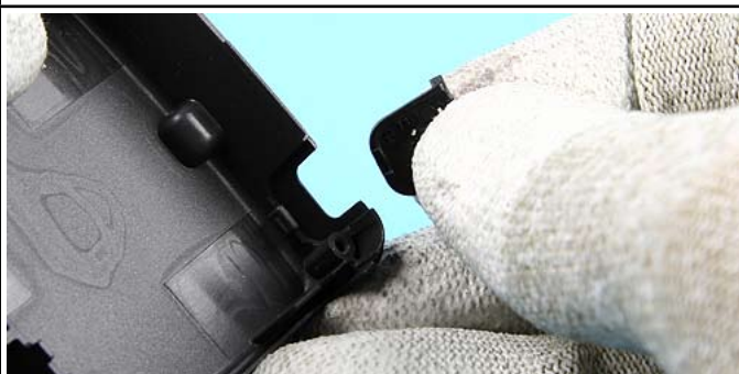
27.) Remove the Power Key.
