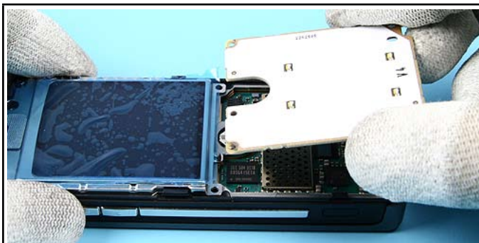
9.) Remove the 1KE UI PWB.
